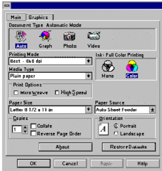
**Nota:** Questa è la finestra di impostazione del driver della Stylus COLOR 500. Nel driver della Stylus COLOR 200 e Stylus 200, il nome dell'opzione stampa a colori diventa **Unità testina** al posto di **Inchiostro**. La funzione rimane la stessa.
